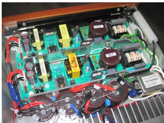
SW 電源は絶縁スペーサを介してシャーシにねじ止め 電荷コンデンサは接着剤でシャーシに取り付けます
